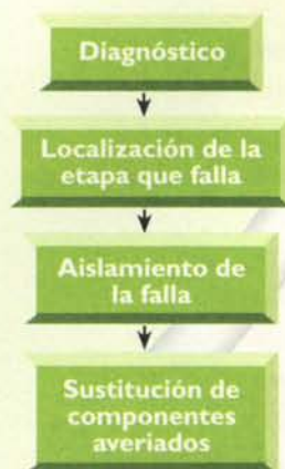
Figura 12.1. Pasos involucrados en el proceso de una reparación
